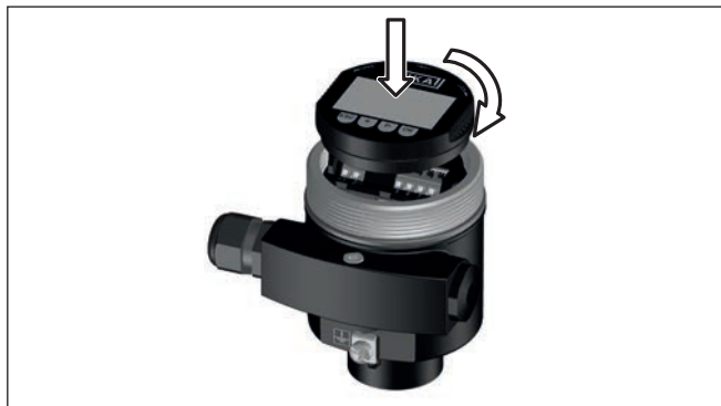
Fig. 37: Colocação do módulo de visualização e configuração na caixa de uma câmara no compartimento do sistema eletrônico
