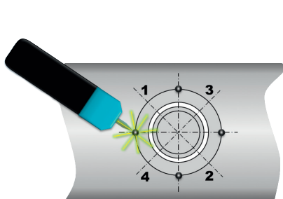
Рис. 1: Выполнение прихваточных швов
