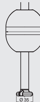
Version avec extrémité de tube soudé
