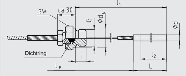
Einbaulänge  $l_1$ :  $\geq 300$  mm bei  $\varnothing d = 6$  oder  $8$  mm
