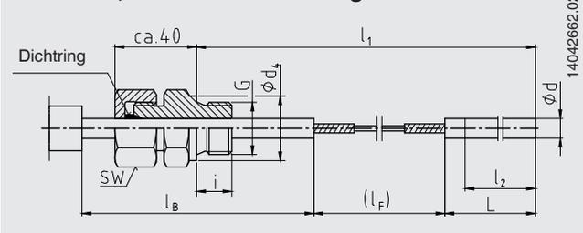
Einbaulänge  $l_1$ :  $\geq 400$  mm
