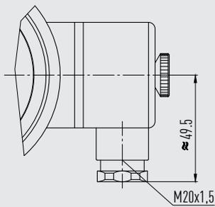
Utilizar únicamente cables de diámetro 7 ... 13 mm
