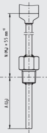
1) При температурах процесса > 150 °C (302 °F), необходимая длина шейки N (M<sub>H</sub>) 70 мм, в противном случае N (M<sub>H</sub>) выбирается (55, 65 или 70 мм).
